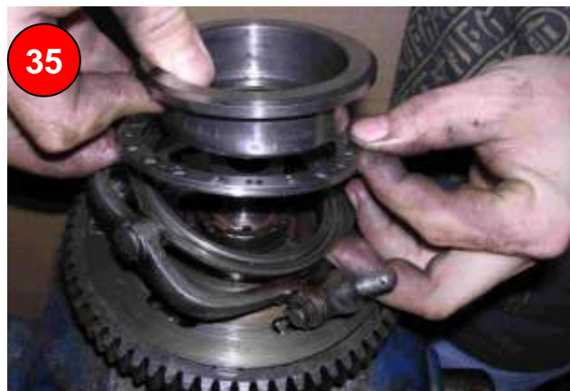
35 Drucklager hochziehen: Achtung 20 Kugeln \varnothing 6 könnten aus dem Korb fallen; Kupplungskorb und Lagerring entfernen
