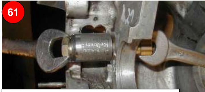
Nockenwellengleitlager im Deckel abziehen
