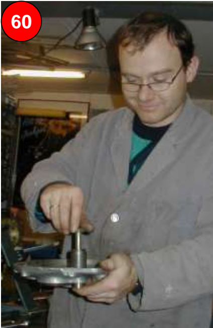
Nockenwellengleitlager im Deckel abziehen
