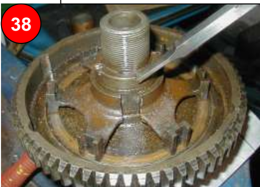
37 Öffnen der Nutmutter: Linksgewinde!!
