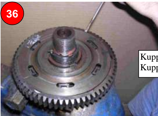
37 Öffnen der Nutmutter: Linksgewinde!!
