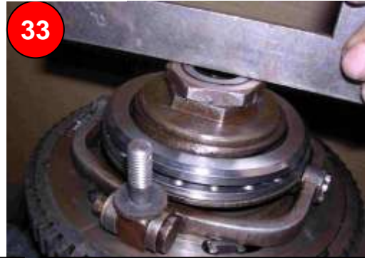
33 Kontrolle Stand der Einschraubtiefe (Maß notieren)
