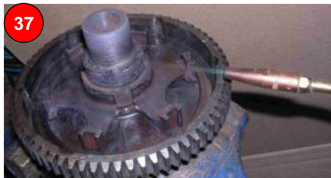
Mutter lässt sich oft nur mit Hitze öffnen, da Schrauben meistens(!) sehr fest. Linksgewinde!!
