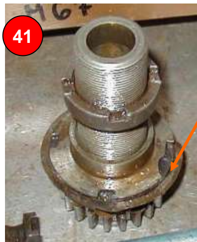
Kontrolle Zustand Zwischenstück
