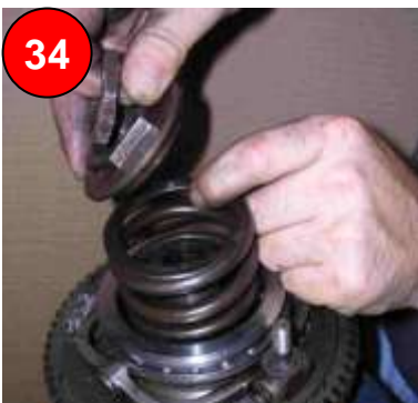
34 Gegenmutter, Haltemutter, Feder entfernen
