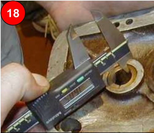
18 Kontrolle Gleitlager im Seitendeckel (max Spiel 0,05- 0,1mm)
