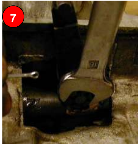
Hebel montieren (läuft im Gleitlager mit wenig Spiel), Mutter anziehen und mit Splint sichern
