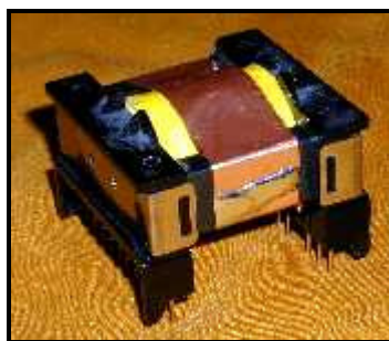
Figuur: HF transformator
